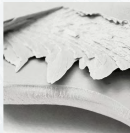
Quando el PVC de estructura amorfa (sección superior) se somete al proceso de orientación, se obtiene una estructura laminar (sección inferior).
