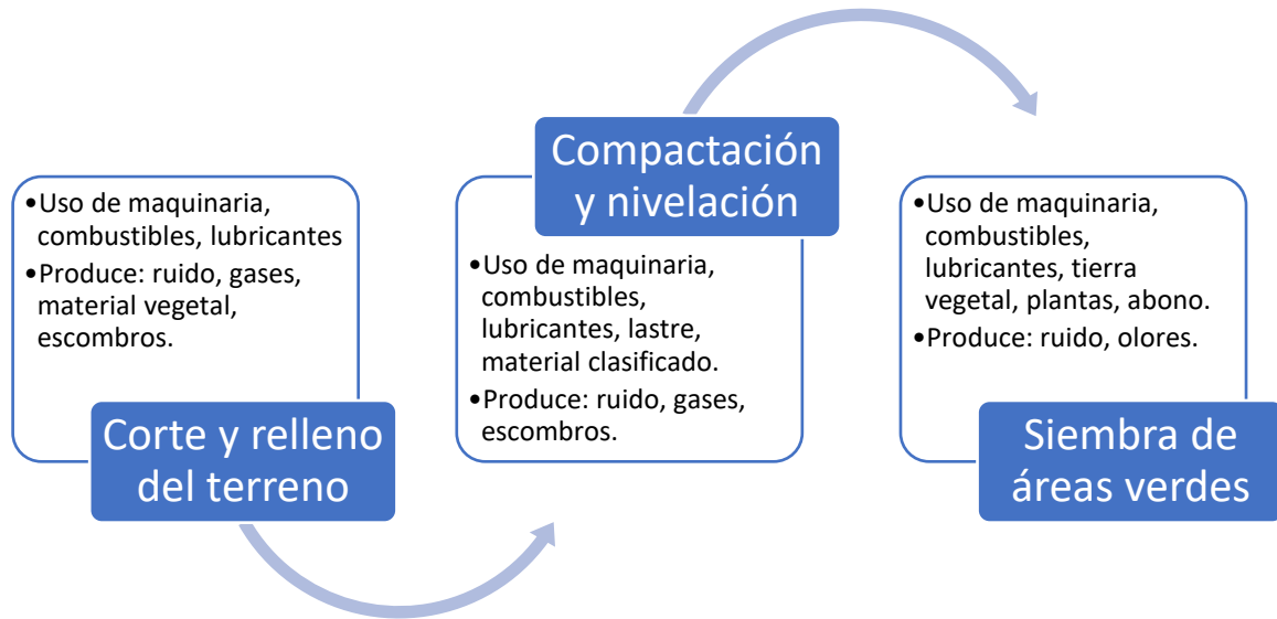
Ilustración 3. Diagrama de flujo del proceso constructivo bodegas a cielo abierto Fuente: Equipo consultor, 2020.
