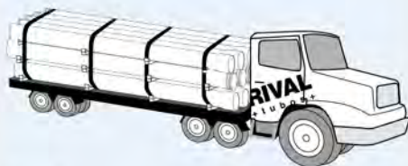
Figura 5 Transporte de tubería sobre camión, apoyos y fajas necesarias.
