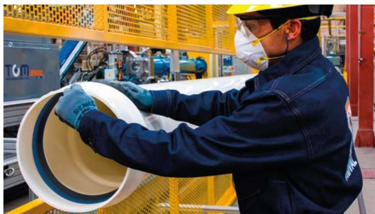
*La tubería TOM es la conducción para el transporte de agua a presión más avanzada tecnológicamente del mercado. Dispone de unas características excepcionales para esta aplicación, generadas fundamentalmente mediante el proceso de orientación molecular.*
