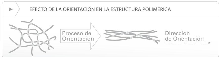
El proceso de orientación molecular modifica la estructura del PVC al ordenar en línea las moléculas del polímero.
