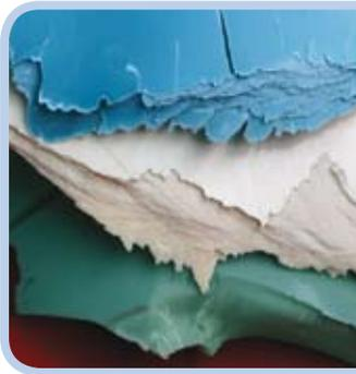
Cuando el PVC de estructura amorfa (sección inferior, de color verde) se somete al proceso de orientación, se obtiene una estructura laminar (sección superior, de color azul).
