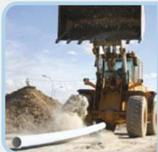
Tras el impacto de una piedra de 500 Kg de peso desde una altura de 3 m, la tubería TOM by RIVAL permanece inalterada.
